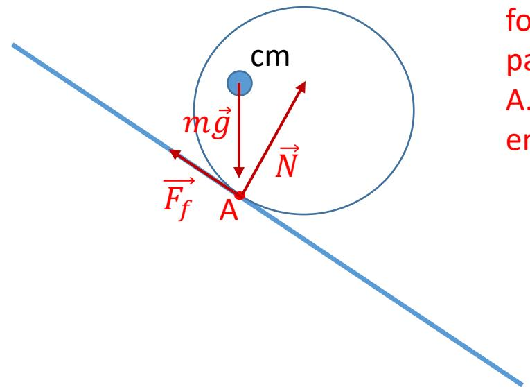
Les moments de force du poids, de la réaction, et de la force de frottement sont nuls par rapport au point de contact
