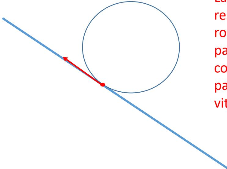
La force de frottement est responsable de la mise en rotation mais elle ne “travaille” pas car la vitesse du point de contact est nulle. Il n'y a donc pas de dissipation d'énergie. La vitesse à l'arrivée est la même.
